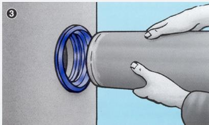
Der im Rohrstutzen eingebaute Montagestop verhindert das Durchschieben des anzuschließenden Rohres.
