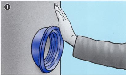
In die vorhandene Öffnung/Bohrloch wird die Dichtung F-910 eingesetzt. Bitte kein Gleitmittel verwenden.
