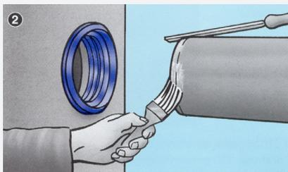
Auf das Spitzende des Anschlussrohres Forsheda Gleitmittel auftragen. Das Rohrende ist entsprechend abzuschrägen.
