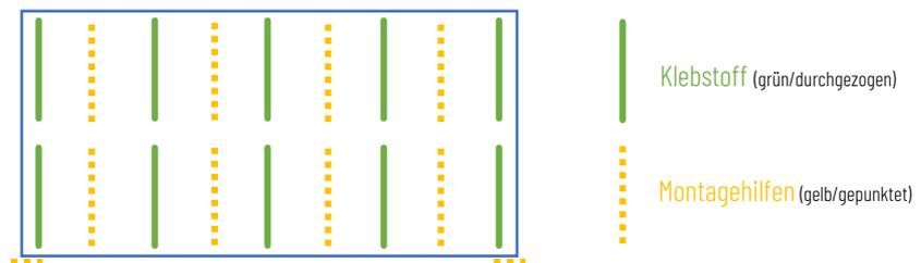
Die Verklebung wurde so gestaltet, dass die Paneele frei auf einem festen, tragfähigen Untergrund vertikal montiert werden kann. Für Serienproduktionen nehmen Sie bitte mit uns vorgängig Kontakt auf.
